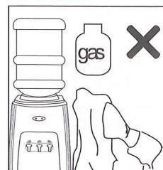
清潔機身時請勿直接浸水清洗，且勿用水擦拭機身，以免引起觸電。亦勿使用汽油、稀釋溶劑以免損壞機身。
